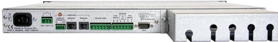
10°) Branchez le **SNA50-5** au réseau électrique 230 volts 50Hz, sur l'embase d'alimentation **N**.
