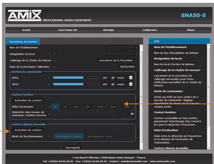
**Fensterkontakt:** wird ein Fenster oder eine Tür geöffnet, kann über diesen Steuerkontakt (Reed-Relais beim Fenster / Tür) ein anderer Grenzwert für die Limitierung aktiviert werden.
