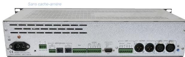
Rückseite des SNA50-3: untere Abbildung ohne Schutzabdeckung (plombierbar) für die Anschlüsse
